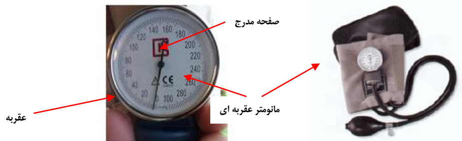
شکل ۷: دستگاه فشارسنج عقربه ای (aneroid monitor)
